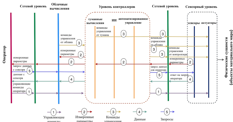
Рис. 1. Схема взаимодействия компонентов системы Интернета вещей
