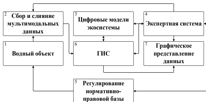
Рис. 2. Модульная архитектура цифрового двойника водного объекта
