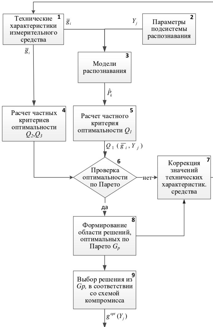
Рис. 1. Процедура расчета оптимальных значений характеристик измерительного средства СТЗ РТК для конкретного варианта подсистемы распознавания
