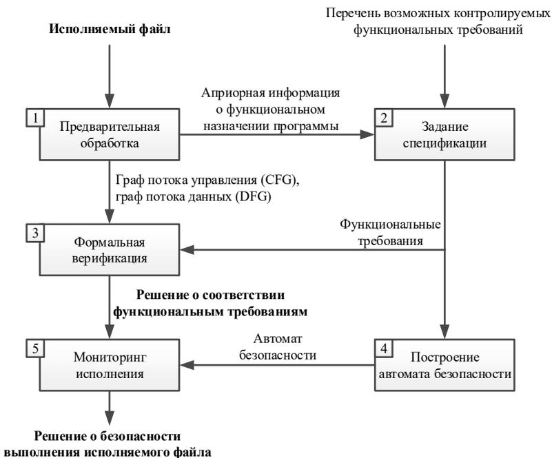
Рис. 2. Функциональная модель системы безопасного исполнения программного кода
