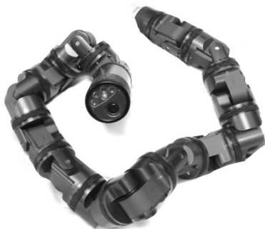
Рис. 4. Змеевидный робот с некомпланарными осями «SEA» (Университет Карнеги Мелон, США)
