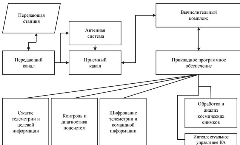
Рис. 3. Типовая архитектура системы обработки информации
