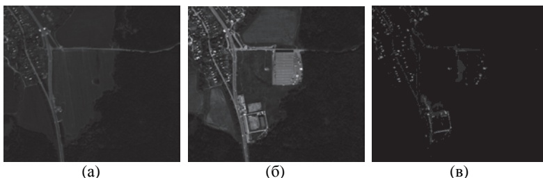
Рис. 4. Выделение отличий с использованием взаимной фильтрации в скользящем окне: (а) предыдущее изображение сцены; (б) текущее изображение сцены; (в) найденные отличия
