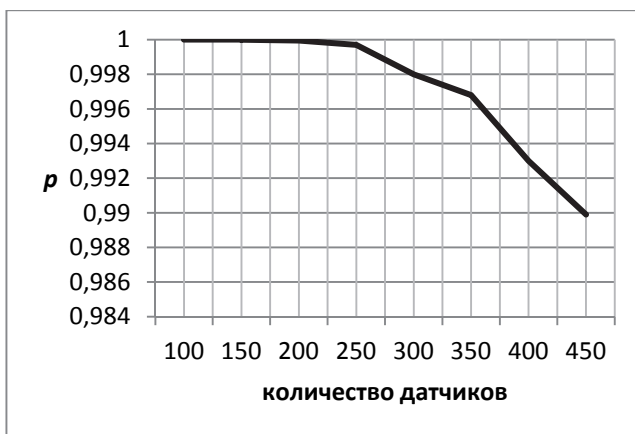
Рис. 5. Зависимость значения вероятности нахождения НСО в момент времени t в поглощающем состоянии от числа датчиков
