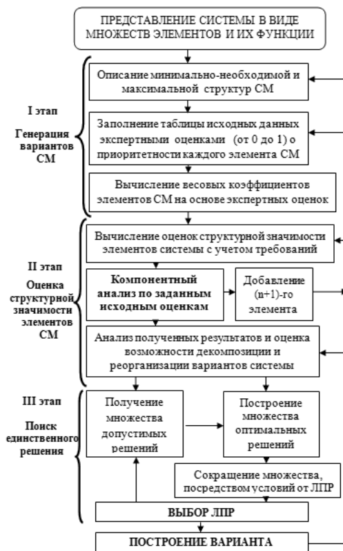
Рис. 1. Метод структурно-функционального синтеза (реструктуризации) ИСЭМ
