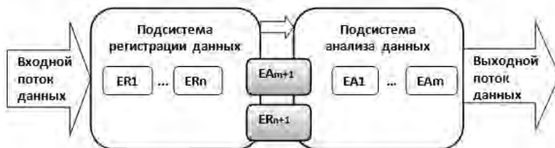
Рис. 6. Переход функций из подсистемы регистрации данных мониторинга в подсистему анализа данных мониторинга
