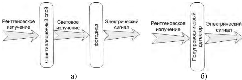
Рис. 3. Схема преобразования информации в детекторах: а) со сцинтилляционным слоем; б) без сцинтилляционного слоя
