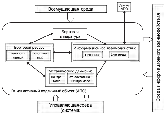
Рис. 1. Общая структурная схема КА как активного подвижного объекта
