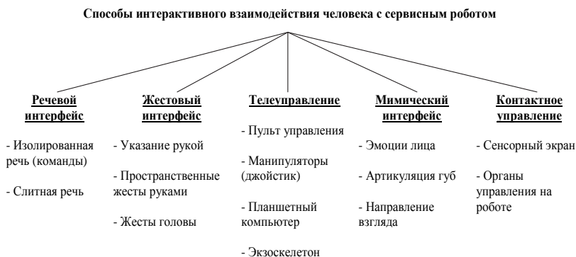
Рис. 6. Варианты построения человеко-машинных интерфейсов для рациональной организации интерактивного взаимодействия космонавта с роботом
