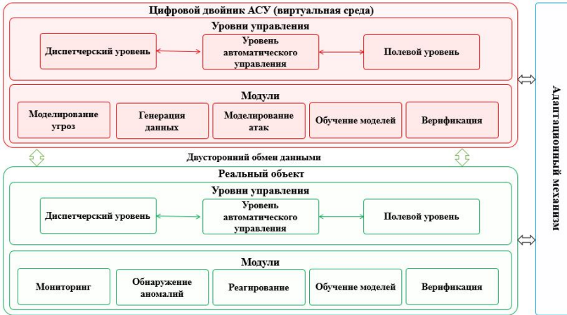
Рис. 1. Общая архитектура адаптивного фреймворка на основе ЦД
