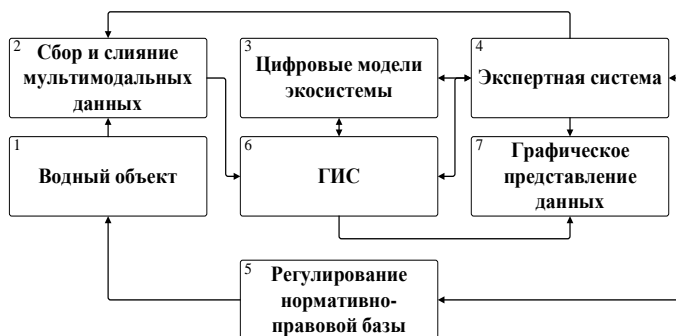
Рис. 2. Модульная архитектура цифрового двойника водного объекта
