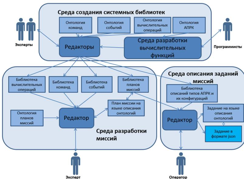
Рис. 1. Архитектура системы планирования миссий АРПК
