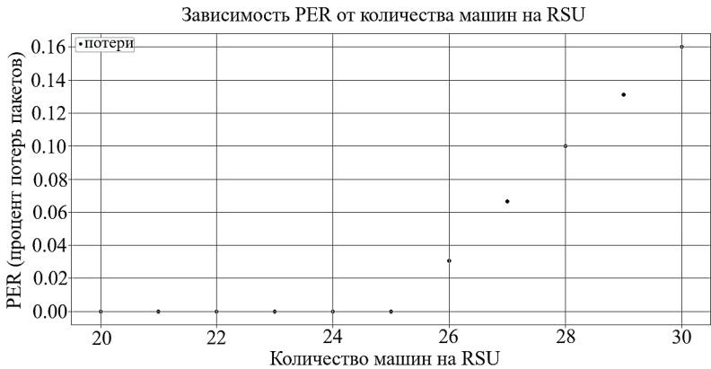
Рис. 5. Зависимость PER от количества подключённых транспортных средств (OBU) к одной RSU
