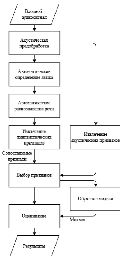
Рис. 2. Архитектура базовой системы определения когнитивных нарушений с помощью языконезависимых признаков по речи [27]
