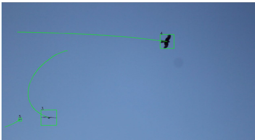
Рис. 8. Демонстрация работы алгоритма по идентификации и отслеживанию траекторий объектов
