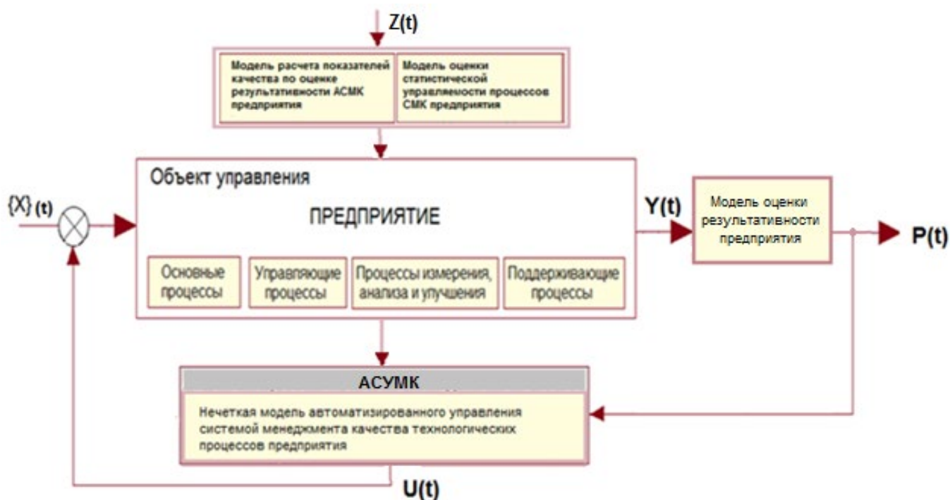
Рис. 3. Структурная схема автоматизированной системы управления менеджментом качества предприятия
