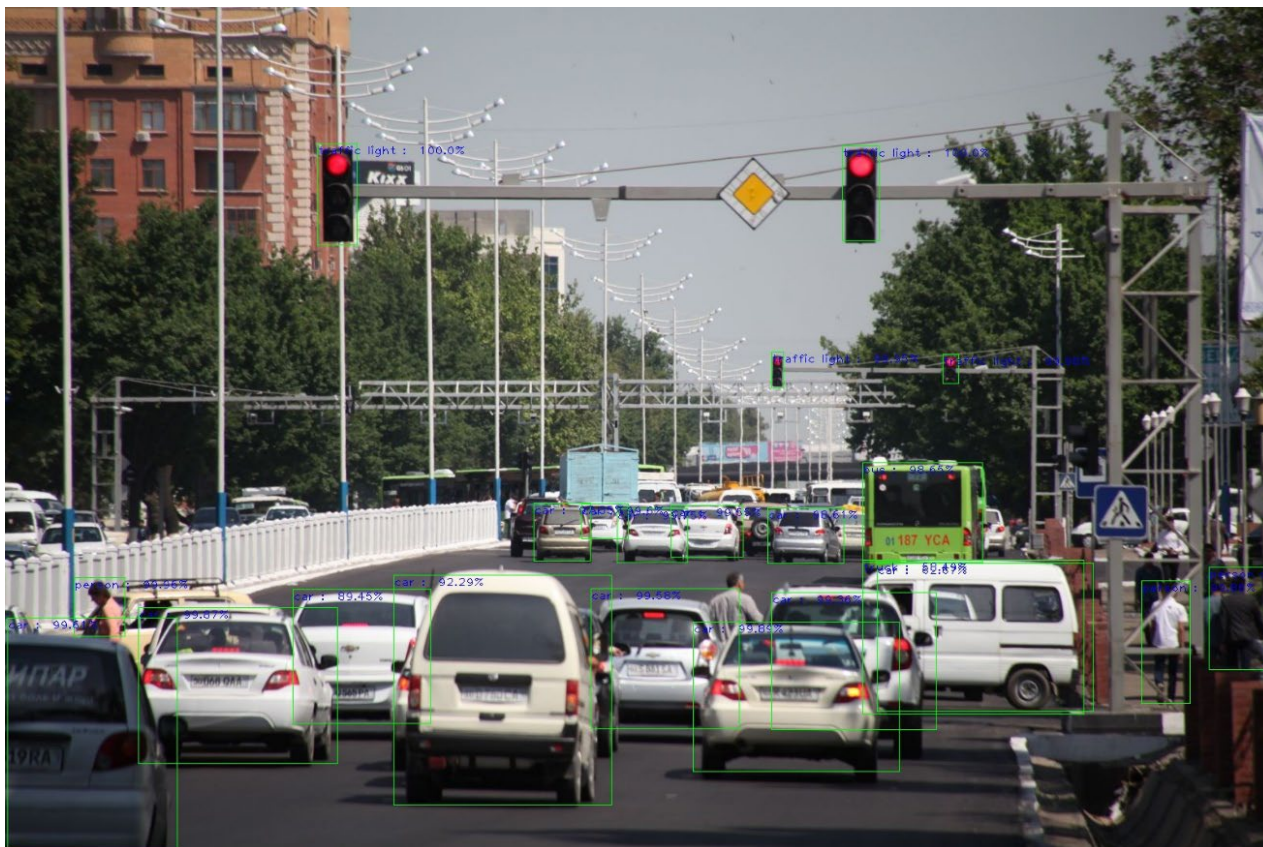
Рис. 4. Результат распознавания объектов на основе модели YOLO
