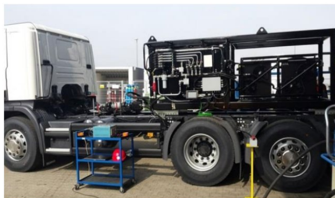
Рис. 1. Испытательный стенд во время испытаний, установленный на шасси Scania
