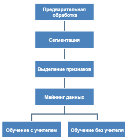
Рис.6. Общий рабочий процесс анализа изображений в секвенаторах
