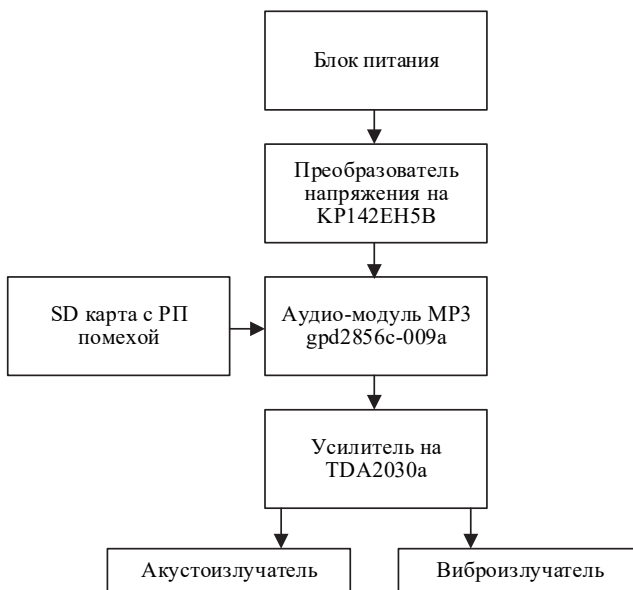
Рис. 21. Блок-схема макета ГРП
