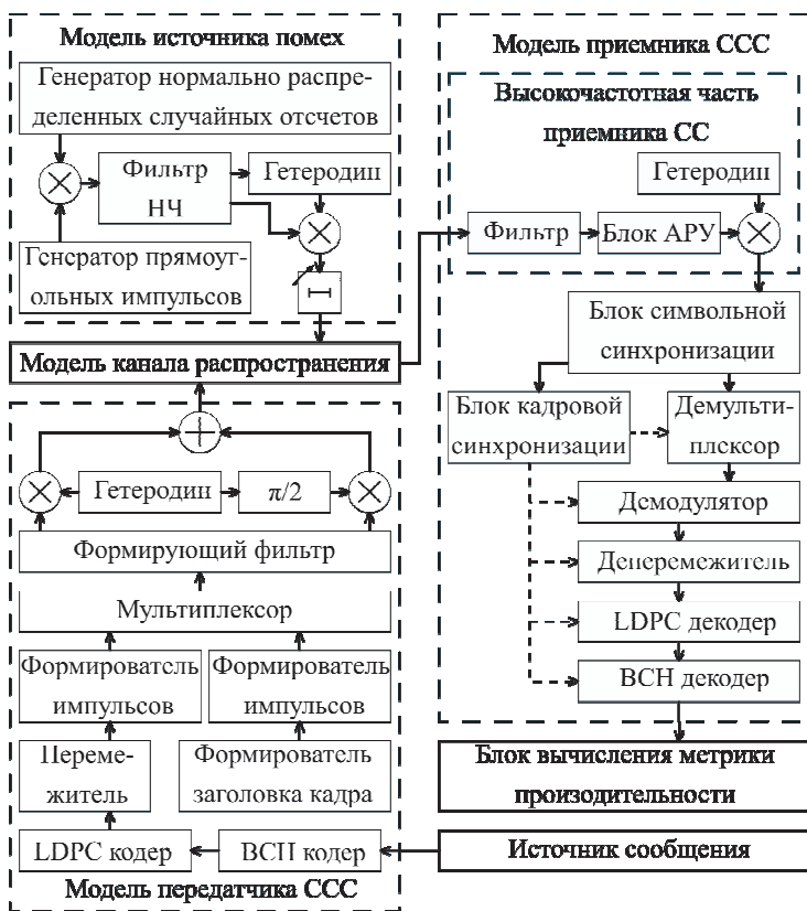
Рис. 4. Структурная схема имитационной модели спутникового канала связи
