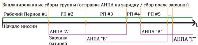
Рис. 2. Декомпозиция миссии на основе циклов зарядки АНПА
