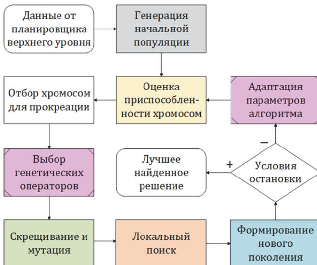
Рис. 8. Блок-схема гибридного эволюционного алгоритма
