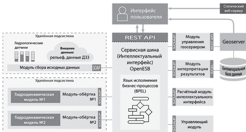
Рис. 2. Обобщенная схема системы оперативного прогнозирования наводнений
