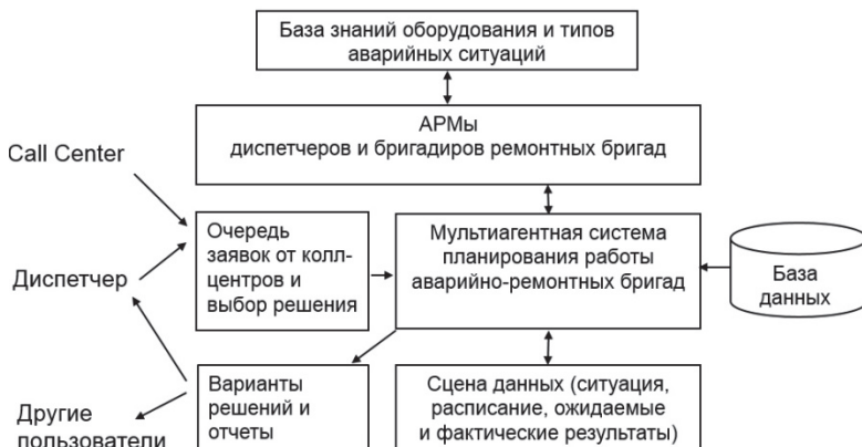
Рис. 3. Логическая архитектура системы адаптивного управления аварийно-ремонтными бригадами
