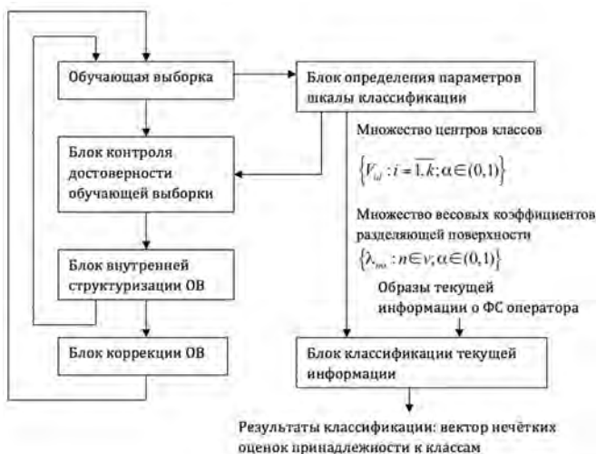
Рис. 5. Структурная схема многомерного размытого классификатора
