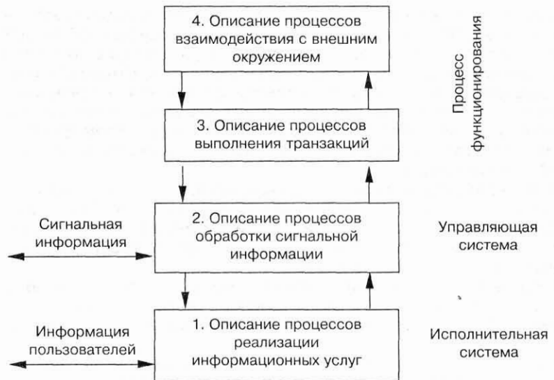
■ Рис. 1. Иерархическая структура моделей
