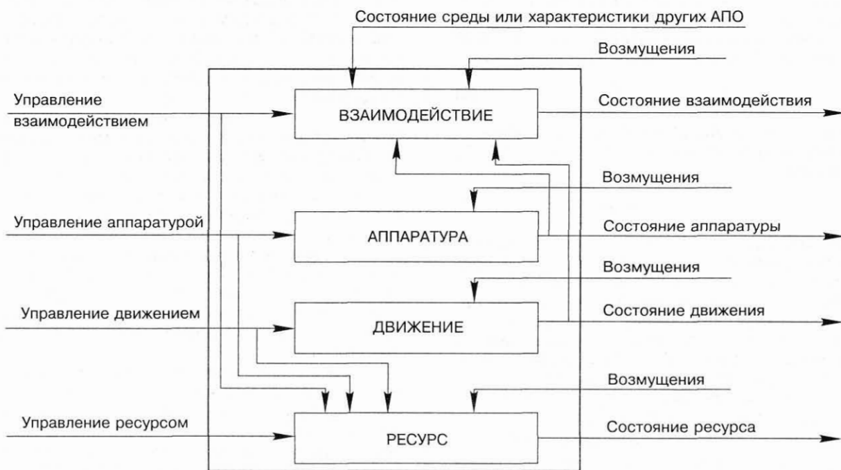
■ Рис. 4. Обобщенная структурная схема активного подвижного объекта (АПО)
