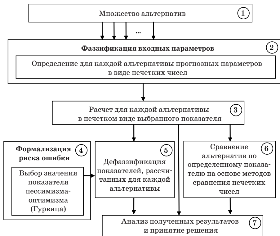
■ Рис. 2. Модель принятия решения в условиях неопределенности, основанная на нечеткой параметризации исходных данных
