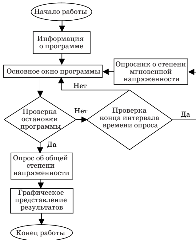
■ Рис. 2. Структура модуля автоматизации оценки напряженности
