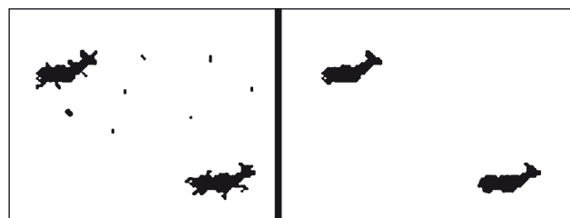
■ Рис. 7. Сглаживание изображения после сегментации: слева — до сглаживания; справа — после сглаживания
