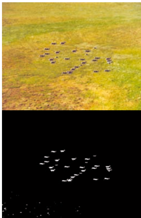
■ Рис. 3. Результаты сегментации изображения пороговым методом: сверху — исходное изображение; снизу — сегментированное
