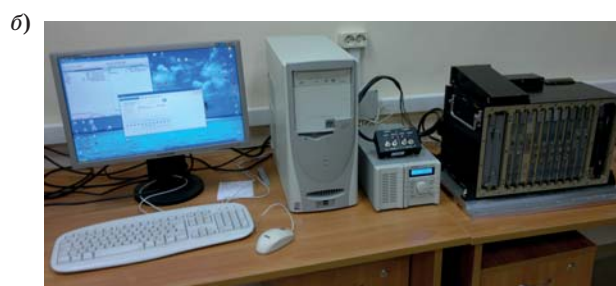
■ Рис. 6. Схема (а) и пример (б) АРМ для проверки БЦВС класса ИМА (БЦВС справа)
