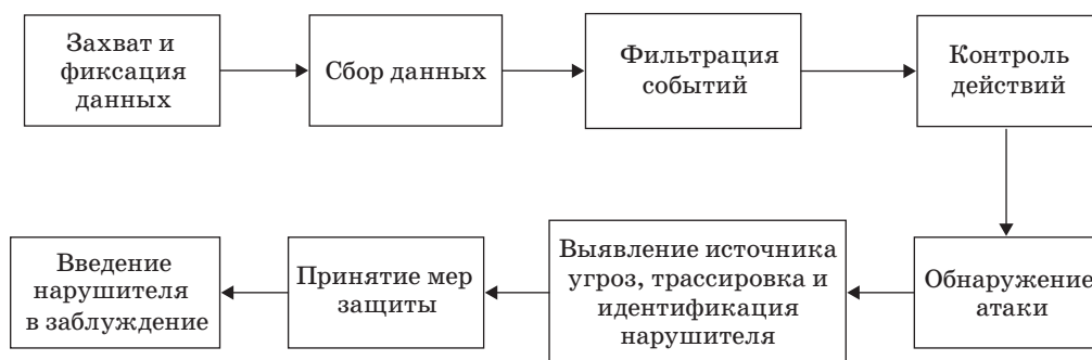
■ Рис. 4. Общий алгоритм анализа действий нарушителя ■ Fig. 4. General algorithm for analyzing the actions of the intruder
