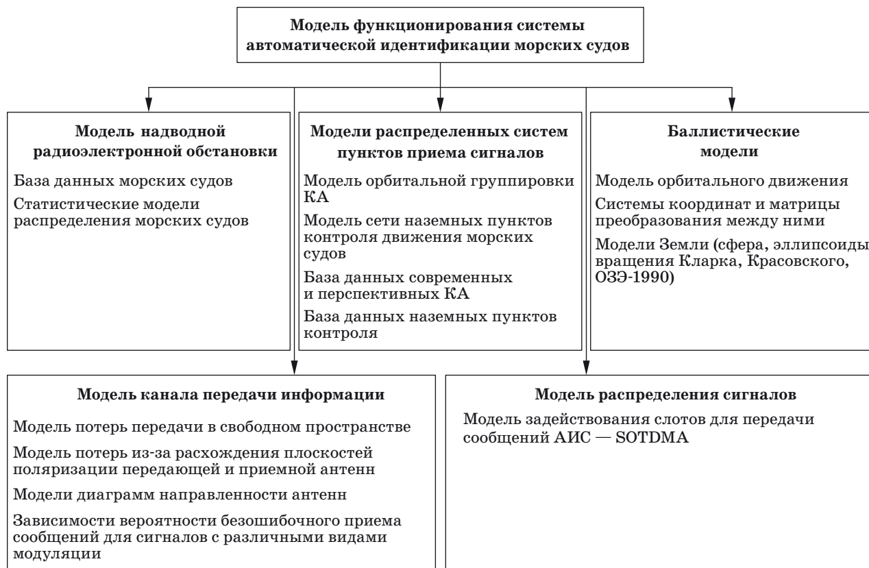
■ Рис. 1. Модель функционирования системы автоматической идентификации морских судов
