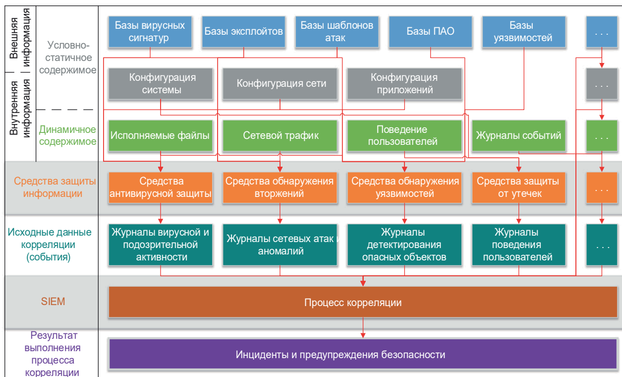
■ Рис. 1. Общая схема использования входных данных для процесса корреляции в SIEM-системах ■ Fig. 1. General scheme of using input data for correlation process in SIEM-systems
