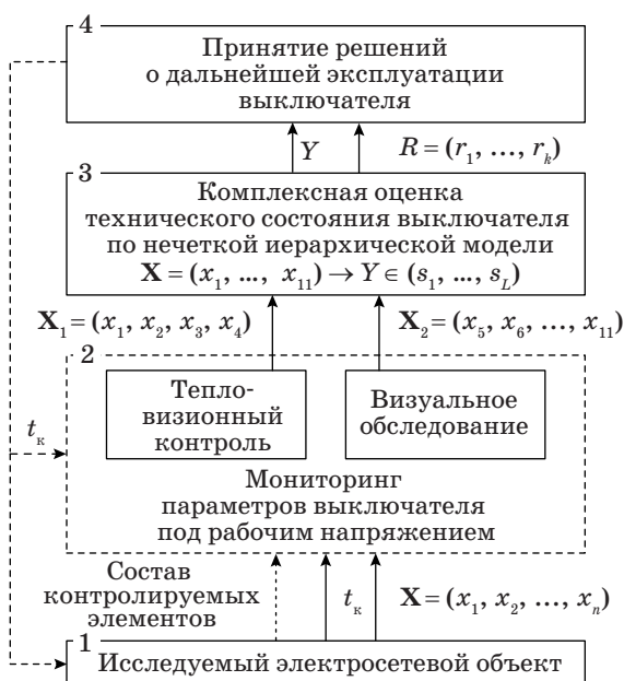
■ Рис. 3. Структурно-функциональная схема принятия решений при обслуживании МВ с мониторингом состояния под рабочим напряжением
