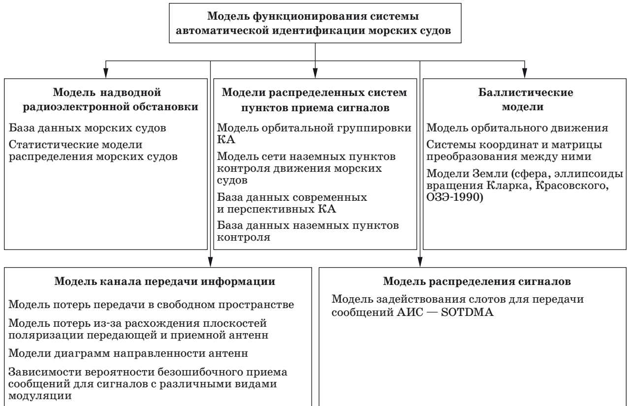
■ Рис. 1. Модель функционирования системы автоматической идентификации морских судов
