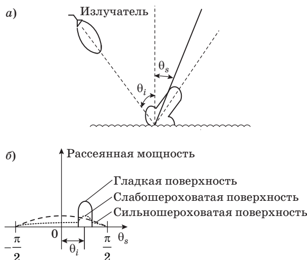
■ Рис. 6. Схема рассеяния волны от шероховатой поверхности (а) и общее представление о диаграмме рассеяния при различной степени шероховатости (б)
