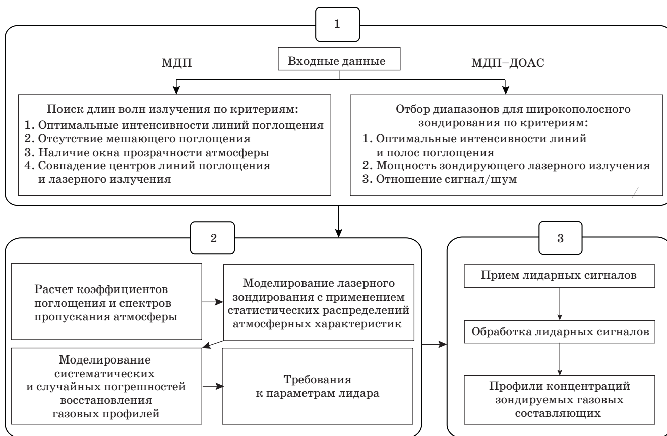
■ Рис. 1. Схема методики планирования и проведения лидарных МДП-ДОАС-измерений ■ Fig. 1. Scheme of planning technique and DIAL-DOAS lidar measurements
