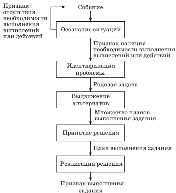
■ Рис. 5. Информационные потоки между моделями поддержки принятия решений ■ Fig. 5. Information flows between decision support models
