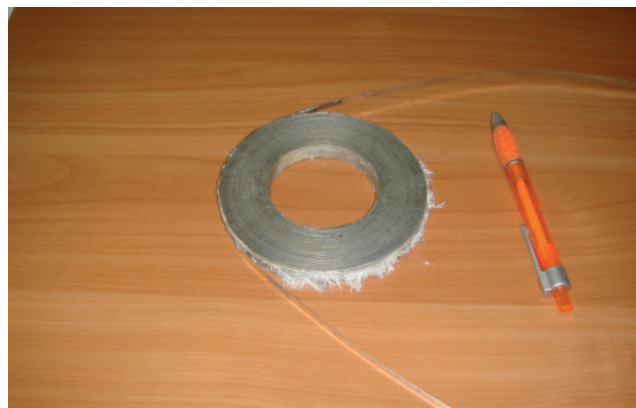
■ Рис. 11. Опытный образец катушки плоского соленоида из ВТСП-ленты
